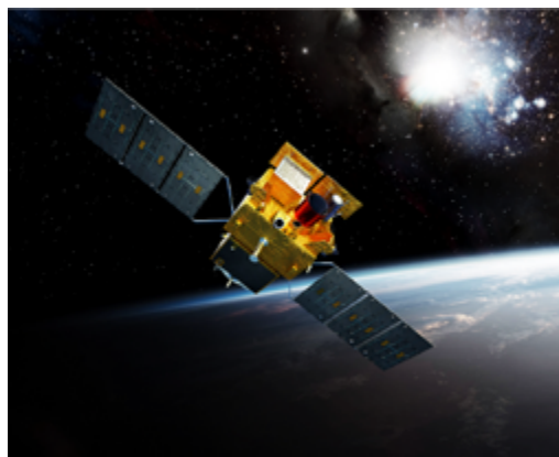
Le satellite Svom embarque quatre instruments d'observation, dont le télescope MXT (cube gris en haut à gauche), domaine d'expertise de l'observatoire.
