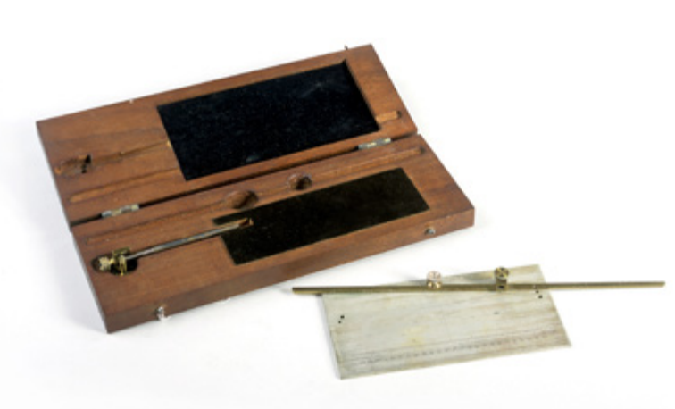
Règle à calcul en laiton et acier pour la résolution de l'équation de Kepler.
