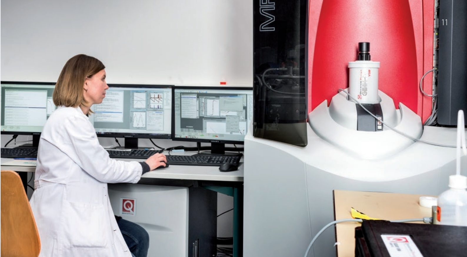
Svetlana Klyatskaya, membre du groupe de recherche de Mario Ruben, analyse les états quantiques de molécules en mesurant leurs propriétés magnétiques sur un magnétomètre SQUID.
