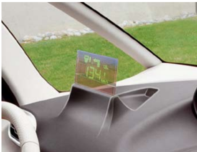
Système vision tête haute mis au point constitué d'un combineur et d'un projecteur
