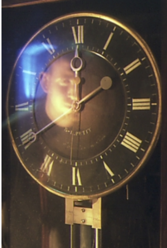
Horloge à balancier B-L. Petit. Donne le temps sidéral et le temps moyen.
