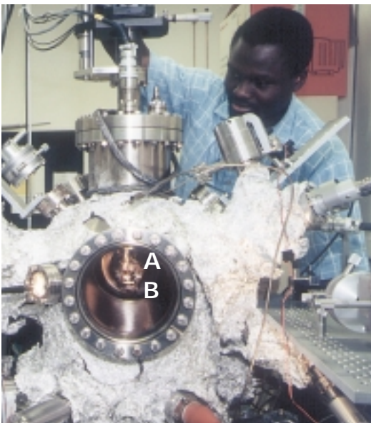
Le système est enfermé dans une enceinte sous ultraviolette pour éviter la présence d'impuretés.
