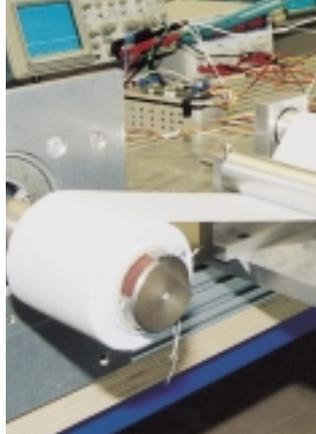
Banc d'enroulement à haute vitesse de bande flexible - Equipe de recherche technologique de l'ULP.
